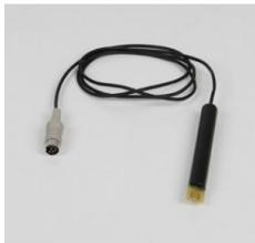
Capteur réalisé en version quatre fils avec capteur de température Pt intégré ; s'utilise avec l'adaptateur chimie ( 524067 ) ou le connecteur adaptateur conductivité S ( 5240671 ) combiné à CASSY ( 524013 , 524006 , 524005W , 524018 ) ou à l'instrument de mesure universel Chimie ( 531836 ).
