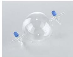
Pour déterminer la masse volumique de l'air en faisant le vide (vide grossier). Sphère en verre avec robinets en verre et olives de raccordement.
