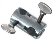
Pour assembler des tiges et des tubes.
