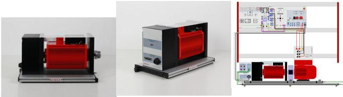
Le dynamomètre électrique est le système de base du système de test de machines pour l'enregistrement de la courbe des machines électriques de la catégorie 0,3•kW dans les quatre quadrants de fonctionnement.
