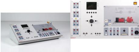
Le test de machines CASSY fait partie du système de test de machines destiné à l'analyse des entraînements électriques et à la simulation des charges des machines. De forme compacte, cet appareil peut être utilisé dans le cadre d'expérimentations ou comme appareil de table.
