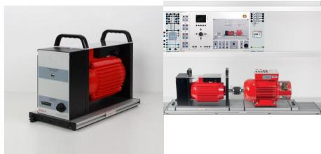
Le dynamomètre électrique est le système de base du système de test de machines pour l'enregistrement de la courbe des machines électriques de la catégorie 1.0 kW dans les quatre quadrants de fonctionnement.
