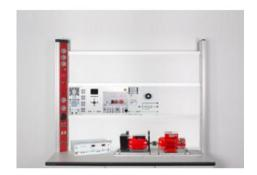
E2.3.2.2 Banc d'essais de moteur universel CC 1.0 kW avec charge active 4 Q, interface PC USB, mesure U I, n, T
