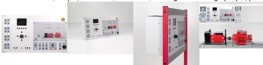
Module de commande CASSY pour l'analyse des machines électriques et à la simulation des charges.
