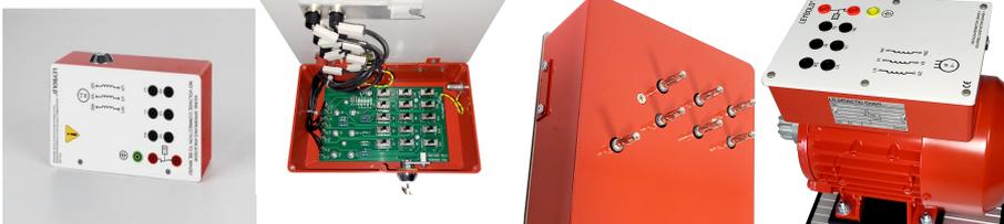
Le simulateur de défauts permet, en combinaison avec les moteurs asynchrones triphasés à cage d'écureuil, de simuler des défauts typiques tels que le défaut à la terre, l'interruption de l'enroulement, le défaut de spire, le défaut d'enroulement et la réponse du thermocontact.
