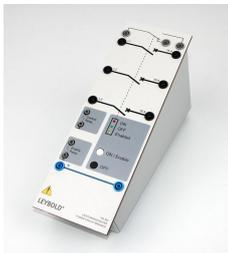
Interrupteur ON/OFF triphasé avec contact auxiliaire (contact inverseur). Commutation manuelle par bouton-poussoir ON/OFF ou externe par l'entrée de commande. L'état de commutation est indiqué par des diodes électroluminescentes. L'interrupteur dispose d'une entrée supplémentaire pour un déclenchement de protection.
