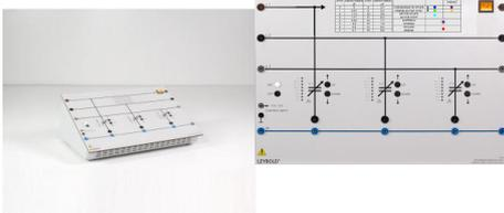
Charge capacitive triphasée, robuste et à usage universel, avec une puissance absorbée réglable jusqu'à 1 kvar. La capacité de chaque phase peut être modifiée individuellement en 15 pas, de 1,7  $\mu\text{F}$  à 26,3  $\mu\text{F}$ . Le pas et l'état de la charge sont affichés par des bandes lumineuses à LED de couleur sur la face avant.
