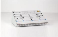
Charge ohmique triphasée, robuste et à usage universel, avec une puissance absorbée réglable jusqu'à 1 kW. La résistance de chaque phase peut être modifiée individuellement en 15 pas, de 2340 ohms à 155 ohms. Le pas et l'état de la charge sont affichés par des bandes lumineuses à LED de couleur sur la face avant.
