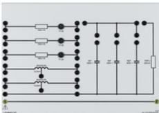
Charge résistive, inductive et capacitive pour tous les montages monophasés et triphasés de l'électronique de puissance.
