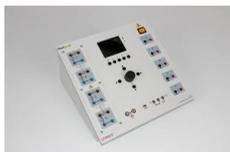
L'analyseur de puissance CASSY est une combinaison d'un oscilloscope sans potentiel et différentiel, d'un multimètre, d'un wattmètre, d'un analyseur d'énergie et d'un enregistreur. Il a été conçu à des fins de démonstration et de laboratoire.
