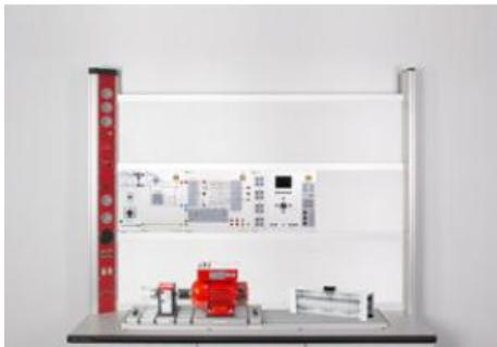
Les essais sont réalisés avec une machine à courant continu de fabrication industrielle. L'alimentation électrique de la machine est assurée par le convertisseur universel.
