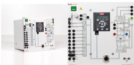
Convertisseur de fréquence industriel didactique avec circuit intermédiaire de tension pour la génération d'une tension de sortie triphasée, variable en fréquence et en amplitude, à partir du réseau alternatif monophasé. Utilisable pour la commande de vitesse et la régulation de vitesse et de couple de machines asynchrones et de machines IPM de la classe de puissance 0,3 kW. Face avant avec schéma fonctionnel pour la représentation de différentes fonctions des entrées et des sorties.
