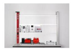
E2.5.3.4 Convertisseur de fréquence industriel pour commander un moteur asynchrone 0.3 kW
