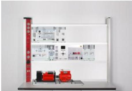
Dans ces essais, le comportement d'un moteur asynchrone est étudié lors d'une mise en marche directe et d'un démarrage étoile-triangle sur le réseau.
