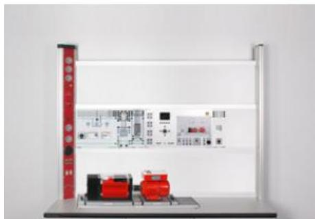
Les machines asynchrones avec une plage de tension de 230/400 V ne peuvent être utilisées qu'en étoile sur un réseau d'alimentation.
