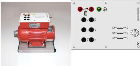
La machine avec une extrémité d'arbre est isolée et construite sur une base en aluminium avec des patins.
