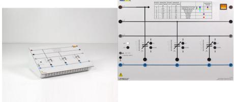
Charge capacitive triphasée, robuste et à usage universel, avec une puissance absorbée réglable jusqu'à 1 kvar. La capacité de chaque phase peut être modifiée individuellement en 15 pas, de 1,7 µF à 26,3 µF.
