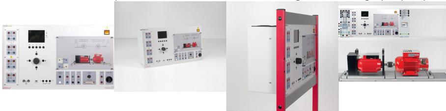
Module de commande CASSY pour analyse des machines électriques et à la simulation des charges.
