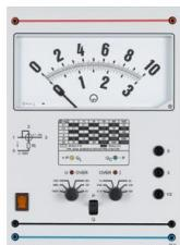
Instrument de démonstration pour mesurer la puissance active, la puissance réactive capacitive et inductive dans une plage de 0,3 W (var) à 30 kW (kvar).
