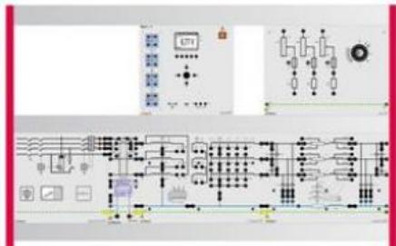
Modèle triphasé d'une ligne de transmission 380 kV avec simulation de 3 longueurs différentes.
