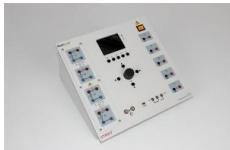
L'analyseur de puissance CASSY est une combinaison d'un oscilloscope sans potentiel et différentiel, d'un multimètre, d'un wattmètre, d'un analyseur d'énergie et d'un enregistreur.
