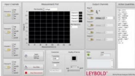
Ce guide décrit le pilotage LabVIEW de l'analyseur de puissance CASSY Plus à l'aide d'un exemple de programme.
