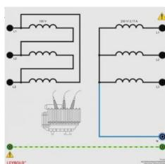
Le transformateur d'alimentation triphasé convertit une tension d'entrée de 150 V (tension entre les conducteurs extérieurs en
