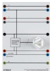
Tube fluorescent compact à luminosité variable avec ballast électronique spécialement pour les actionneurs commutateurs/variateurs.
