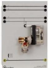
Commande proportionnelle, ne requierant aucun service d'entretien, pour la connexion directe au bus EIB avec moteur, organe de transmission, reconnaissance de course, électronique de communication et de commande. Boîtier transparent pour raisons didactiques. Alimentation bus EIB. Une coupe de vanne thermostatique illustre le fonctionnement de l'électromoteur.
