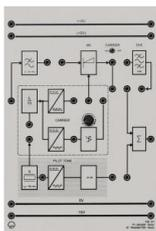
Cet appareil permet l'étude de différentes modulations d'amplitude (AM), par ex.:
