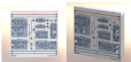
Module d'émission compact (TPS) pour la génération d'un signal de moins de 50nW dans la bande VHF (88-100MHz).
