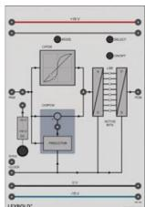
Dans le modulateur PCM (MIC), le signal échantillonné, à valeurs discrètes en temps, est quantifié et codé. À partir du signal d'entrée analogique du modulateur PAM, on obtient un signal entièrement numérique (à valeurs discrètes en temps et en amplitude). Le modulateur PCM permet l'étude de la quantification linéaire et non linéaire. La plaque sert en outre à étudier les signaux DPCM (modulation MIC différentielle).
