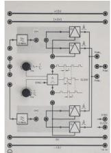
La modulation d'impulsions en amplitude (PAM) est réalisée par échantillonnage d'un signal analogique. Elle est l'étape préalable à la génération de signaux PCM (MIC).
