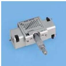
Un déphasage de l'onde hyperfréquence peut être obtenu à l'aide d'une petite lame diélectrique mobile placée à l'intérieur du guide d'ondes.
