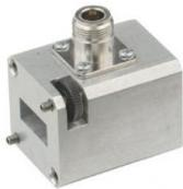
La transition est destinée à la conversion d'ondes TE10 d'un guide d'ondes en ondes TEM et inversement. Cette transition est nécessaire pour le raccordement du détecteur coaxial.
