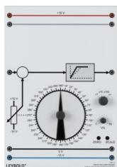
Transmetteur de position avec disque rotatif gradué en angle pour une utilisation dans des systèmes asservis.
