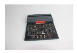
Le cours COM4LAB « Technique numérique en automobile (notions de base) » traite les principes fondamentaux de l'algèbre de Boole à l'aide d'opérations logiques.
