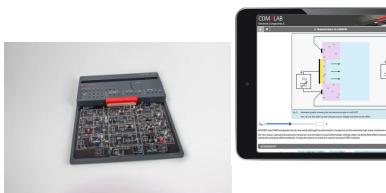
Le cours COM4LAB « Composants électroniques II » est le deuxième cours sur les composants électroniques actifs qui ont un effet d'amplification ou permettent des fonctions de commande.
