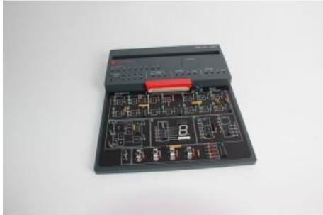
Le cours COM4LAB « Technique numérique I » est le premier cours sur les bases de la technique numérique. Les principes fondamentaux et les lois de l'algèbre de Boole sont étudiés à l'aide d'opérations logiques. Ce cours qui se compose de 16 chapitres aborde également en détail la recherche des défauts.
