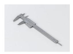
L'expérience P1.1.1.1 consiste à déterminer les dimensions extérieures et intérieures dun objet à mesurer à laide dun pied à coulisse.
