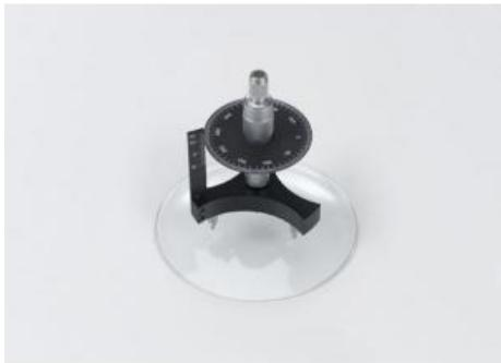
L'expérience P1.1.1.3 consiste à déterminer les rayons de courbure R de verres de montre à l'aide d'un sphéromètre.
