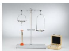
Pour mesurer la densité de liquides, on dispose du corps plongeur dans l' expérience P1.1.2.2.
