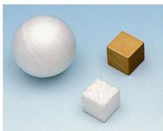
Pour des expériences sur la masse volumique et la poussée d'Archimède avec des corps en différents matériaux.
