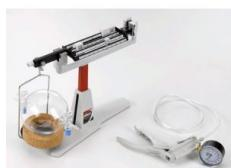
Dans l'expérience P1.1.2.4, la densité de l'air est déterminée à l'aide d'une sphère à deux robinets, de volume connu.
