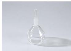
Pour mesurer la densité de liquides, on dispose du pycnomètre de Gay-Lussac dans l'expérience P1.1.2.3. Il sagit de déterminer la densité de mélanges d'eau et de déthanol.
