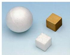
Pour des expériences sur la masse volumique et la poussée d'Archimède avec des corps en différents matériaux.
