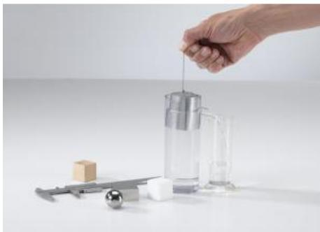
Pour mesurer la densité de corps solides, on établit un lien entre une pesée et une mesure de volume. Les volumes des corps sont déterminés daprès le volume de liquide quils déplacent dans un récipient. Dans l' expérience P1.1.2.1, on prend lexemple de corps réguliers dont le volume peut être calculé à partir de leurs dimensions linéaires.
