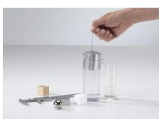
Pour mesurer la densité de corps solides, on établit un lien entre une pesée et une mesure de volume.
