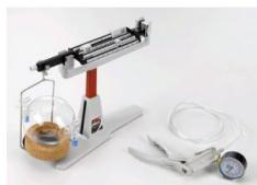
Dans l' expérience P1.1.2.4, la densité de l'air est déterminée à l'aide d'une sphère à deux robinets, de volume connu.
