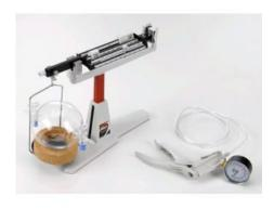
Dans l'expérience P1.1.2.4, la densité de lair est déterminée à laide dune sphère à deux robinets, de volume
