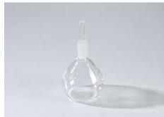
Pour mesurer la densité de liquides, on dispose du pycnomètre de Gay-Lussac dans l'expérience P1.1.2.3.
