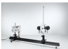
Le mouvement des sphères de plomb dans la balance de gravitation peut être suivi automatiquement avec le détecteur de position à infrarouge (IRPD: IR Position Detector).
