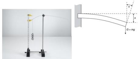
Dans l' expérimentation P1.2.1.2, on étudie la flexion d'un ressort à lame serré d'un seul côté et soumis à l'action d'une force connue, obtenue en suspendant des masses marquées.
