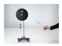
Dans l'expérience P1.2.3.2, on explique léquilibre de couples de rotation avec une poulie. Les notions de force, de bras de puissance et de ligne daction y sont étayées expérimentalement. Il est explicitement mis en évidence que la valeur du couple de rotation ne dépend que de la force et de la distance entre la ligne daction et laxe de rotation.
