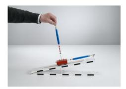
P1.2.5.1 Force de résistance et force normale sur le plan
