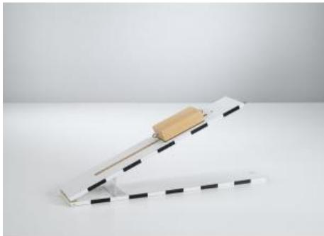
Dans l'expérience P1.2.5.2, on utilise le fait que la force normale dépende de l'angle d'inclinaison afin de déterminer quantitativement le coefficient de frottement statique  $\mu$  d'un corps. L'inclinaison du plan est augmentée jusqu'à ce que le corps perde son adhérence et commence à glisser.
