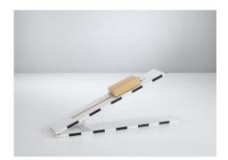
P1.2.5.2 Détermination du coefficient de frottement statique avec le plan incliné
