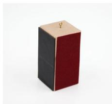
Bloc de bois pour les essais de frottement. Avec crochet latéral pour fixer un dynamomètre. Les frottements de glissement et d'adhérence de quatre matériaux différents (bois, caoutchouc, velours, papier abrasif) peuvent être comparés.
