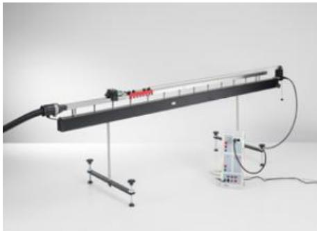
L'expérience P1.3.3.5 consiste à tracer le déplacement, la vitesse et l'accélération d'un mobile qui monte sur un banc à coussin d'air incliné, s'immobilise puis redescend et rebondit sur l'extrémité élastique, faisant ainsi plusieurs va-et-vient.
