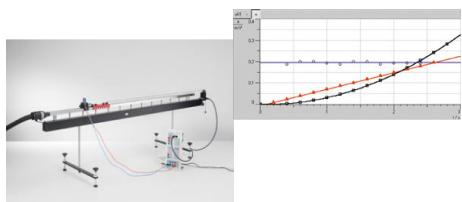
Les mouvements uniformes et uniformément accélérés sur le banc à coussin d'air en position horizontale font l'objet de l'expérience P1.3.3.4.
