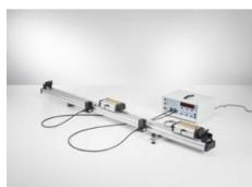
Durant l'expérience P1.3.4.6, on mesure le temps  $t$  durant lequel les faisceaux de deux barrières lumineuses sont interrompus par deux mobiles placés sur le rail à chariot, avant ou après un choc élastique ou inélastique.
