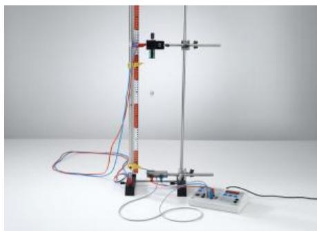
Au cours de l' expérience P1.3.5.1, la mesure électronique du temps est lancée dès que la bille est libérée par l'interruption du courant magnétique.
