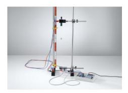
P1.3.5.1 Chute libre : mesure du temps avec plaque de contact et compteur S
