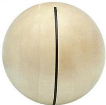
Pour déterminer expérimentalement le moment d'inertie.
