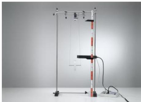
Dans l'expérience P1.4.6.1, on étudie la conservation de l'énergie à l'aide de la roue de Maxwell. Lors de cette expérience, l'énergie potentielle Epot est transformée en énergie cinétique Ekin composée d'un mouvement linéaire Etrans et d'un mouvement de rotation Erot.
