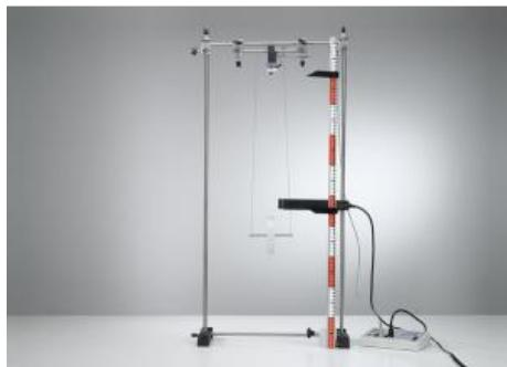
Dans l'expérience P1.4.6.1, on étudie la conservation de l'énergie à l'aide de la roue de Maxwell. Lors de cette expérience, l'énergie potentielle Epot est transformée en énergie cinétique Ekin composée d'un mouvement linéaire Etrans et d'un mouvement de rotation Erot.
