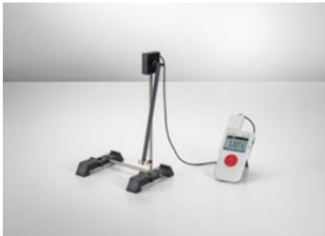
Dans l'expérience P1.5.1.3 on étudie l'oscillation d'un pendule à tige qui représente un pendule de physique simple.
